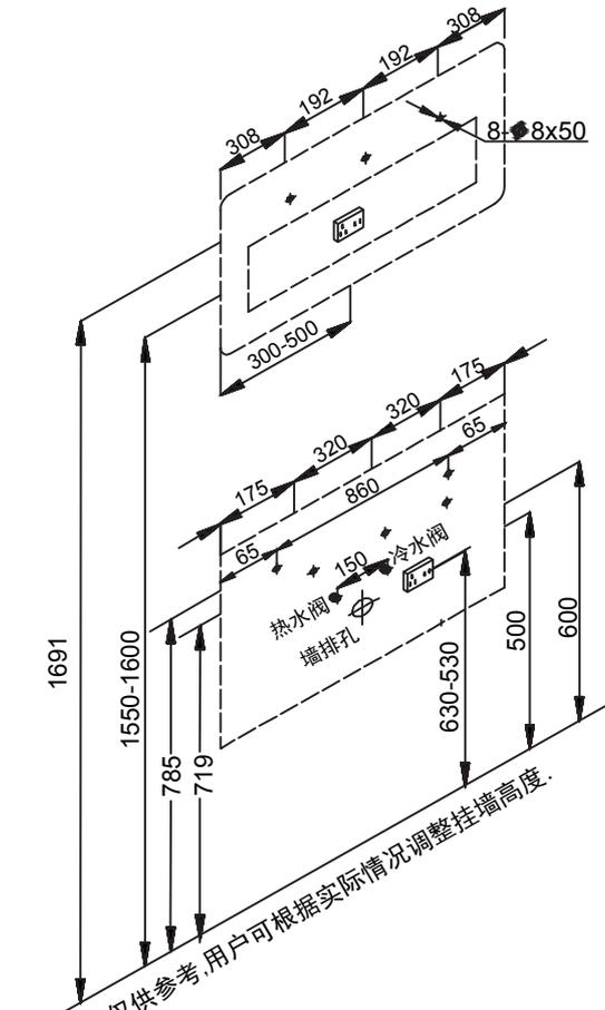
1: 在安装前必须清楚了解钻孔位置是否有水管, 电线。
